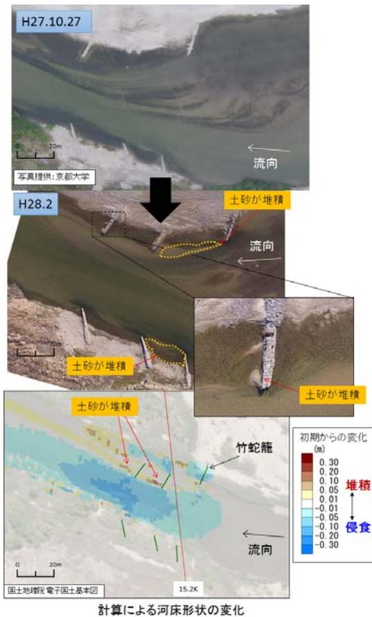
図-12 航空写真と計算結果 (CASE1)
