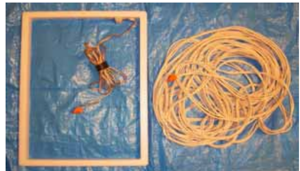
写真-2 左：ループアンテナ（29.5cm×42cm） 右：ケーブルアンテナ（ループ部 24m×3T）
