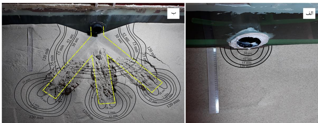
شکل ۶- توسعه زمانی مخروط رسوب شویی در (الف) آزمایش شاهد و (ب) بهترین عملکرد سازه
