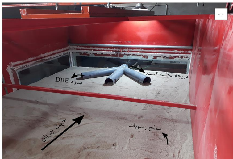
شکل ۳- الف) شمای کلی سازه DBE و ب) نحوه قرارگیری آن در مخزن
