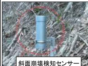
斜面崩壊検知センサー
